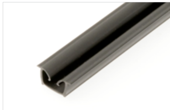
Guarnizione interna rigida per pannelli e/o vetri con spessore da 3 a 5 mm. Lunghezza barre: 5000 mm.
