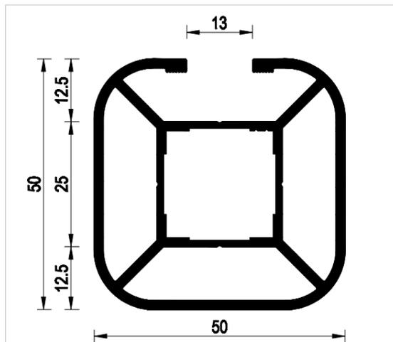
Profilo in alluminio estruso colonna - traversa a una via.
