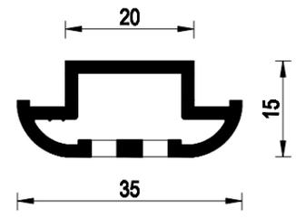
Profilo in alluminio estruso fresato doppio passo 25 mm + 25 mm.
