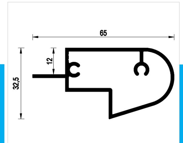
Profilo in alluminio estruso reggimensola anteriore. Accoppia con A8290. Lunghezza barre: 6000 mm.
