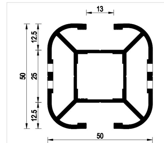
Profilo in alluminio estruso colonna fresato doppio passo 25 mm + 25 mm.
